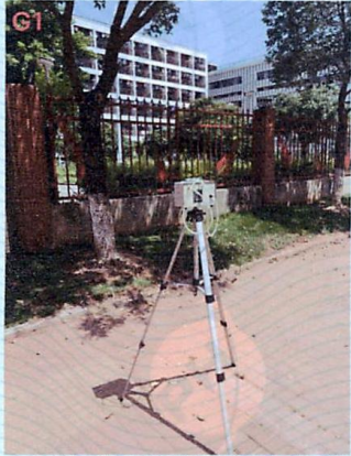
G1 厂界废气无组织排放上风向参照点
