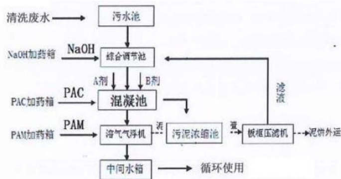
图 2-10 工业废水净化回用工艺流程图
